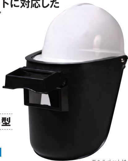
面の裏の溝にツバをはめ バンドを後部にまわし装着
